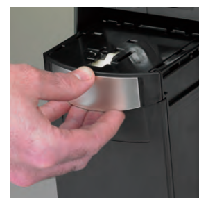
Griff für die Herausnahme der Banknotenkassette
